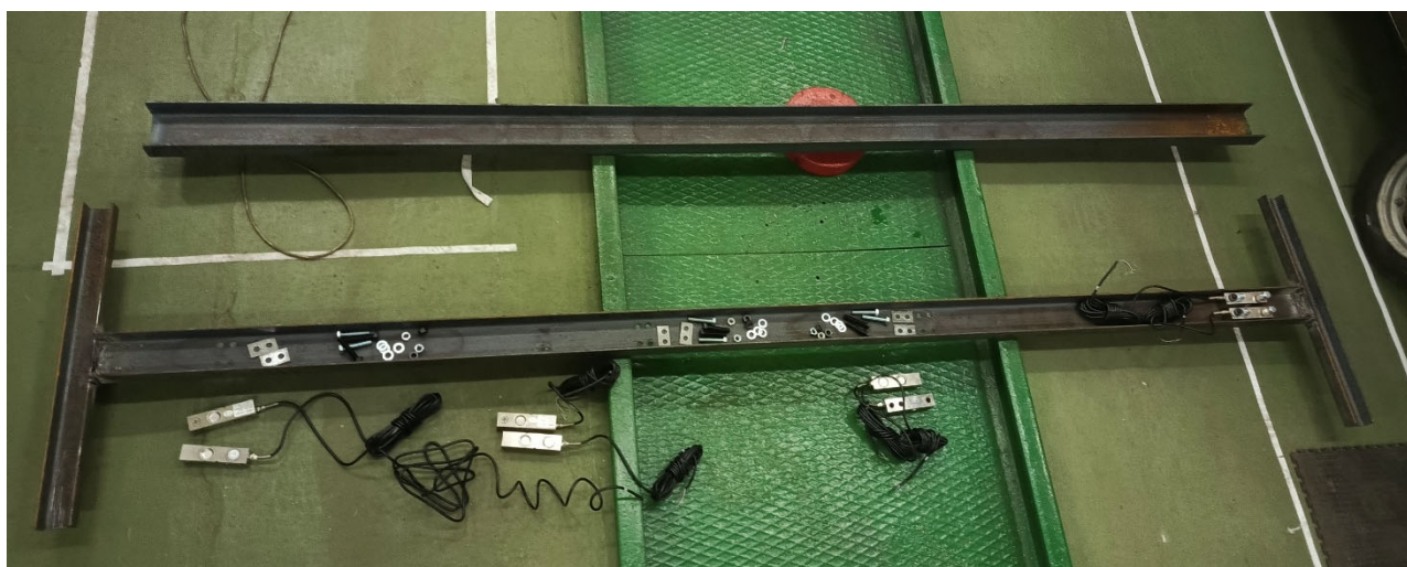
Рисунок 4 – Кришка та основа вимірювальної вантажної платформи Figure 4 – Cover and base of the measuring load platform
