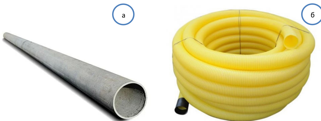
Рисунок 1 – Бетонна (а) та ПВХ (б) дренажні труби, що використовуються в експериментальних дослідженнях
