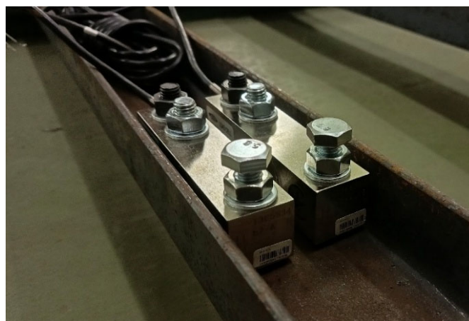
Рисунок 6 – Попарне розміщення тензодавачів LOCOSC LP7110-2t C3 в швелері У10 основи вимірювальної вантажної платформи Figure 6 – Pairwise placement of LOCOSC LP7110-2t C3 strain gauges in the channel U10 of the base of the measuring cargo platform
