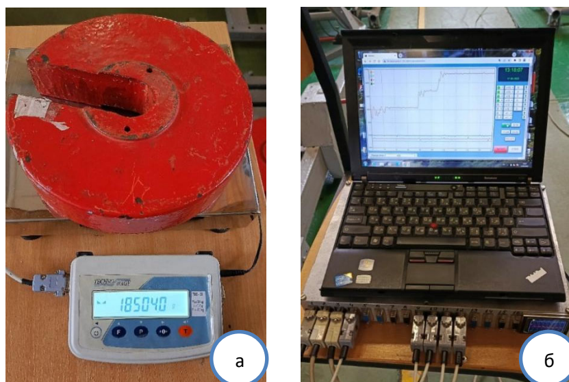
Рисунок 11 – Визначення маси тарованого вантажу на контрольних вагах TECHNO WAGY (а); загальний вигляд багатоканального вимірювально-реєструючого комплексу (б) Figure 11 – Determination of the mass of a tare load on TECHNO WAGY checkweighers (a); general view of the multi-channel measuring and recording complex (b)
